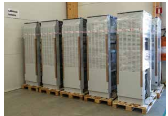
Kempowerin tehoyksikkökaappeja lähdössä asiakkaalle. Kuhunkin kaappiin voidaan sijoittaa 1-4 tehomodulia, kukin teholtaan 50 kW.
