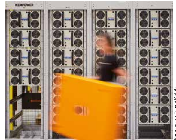
Tehoyksikön tehomodouleja tuotannossa. Tehoyksikköön voidaan asentaa 1-4 tehomodulia, kukin teholtaan 50 kW.
