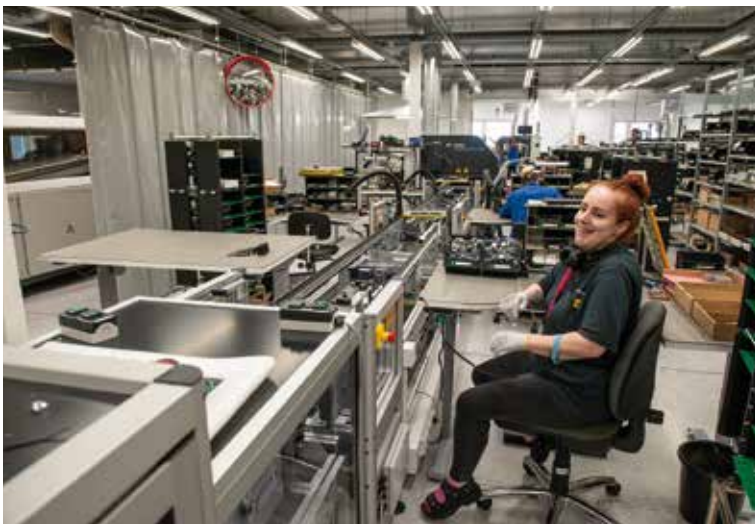
Satu Leiviskä tekee visuaalista tarkastusta ja ladontaa. Taustalla uusi aaltojuotuskone, jonne linja vie ladotut piirilevyt.
