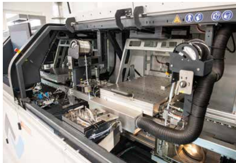
Katsaus selektiivijuotuskoneen sisuksiin. Koneen toimiessa kannet ovat kiinni ja typpikaasu estää tinan hapettumista.
