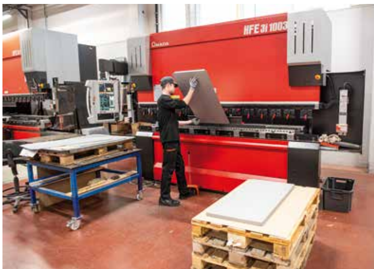
Uusi Amada HFE3i -särmäyspuristin täydentää vanhempien särmäyspuristinten rivistöä ja tuo työhön lisää nopeutta ja mukavuutta.
