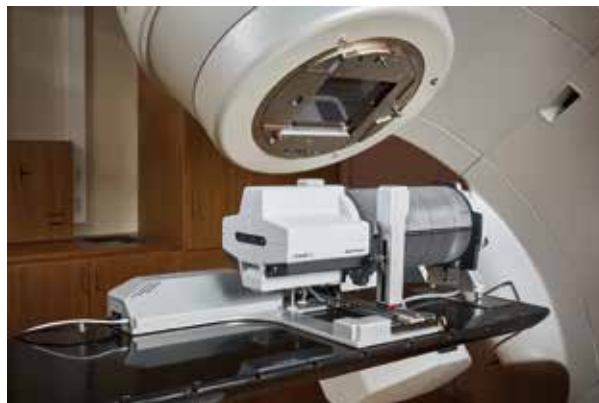
Delta4 Phantom+ varustettuna HexaMotion-lisälaitteella, joka simuloi potilaan hengitystä ja liikkumista ja auttaa varmistamaan oikean säteilyannoksen kohteeseen.
