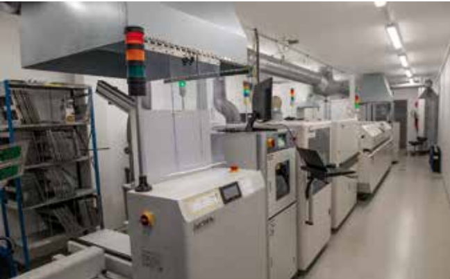
Uudistetulla lakkalinjalla voidaan nyt käyttää useita erilaisia lakka- laatuja, kuten UV- tai akryyliakkaa.
