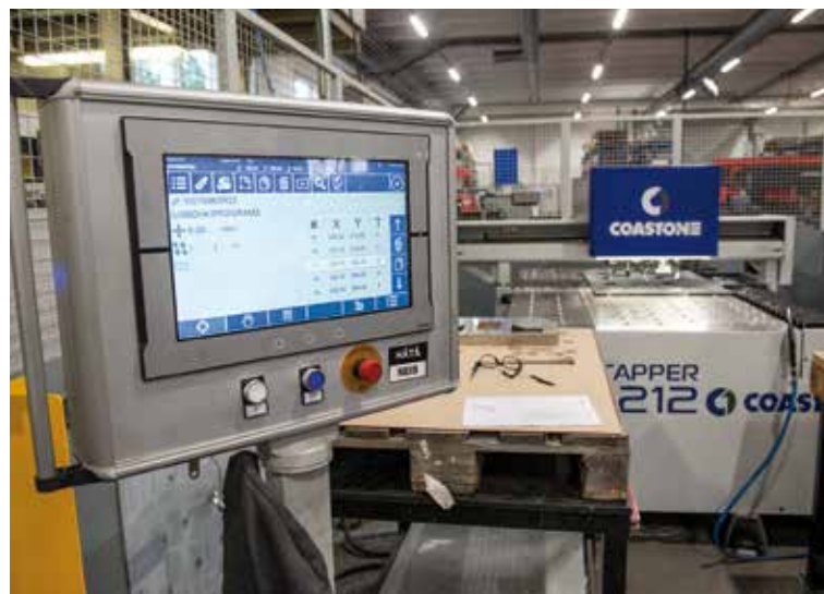
TapOne Multitapper -koneen kätevä kosketusnäyttö antaa mahdollisuuden helppoon kierteytyksen ja senkkausten ohjelmointiin. Vaihtoehtoisesti koneelle on mahdollista tuoda valmis CAM-tiedosto.
