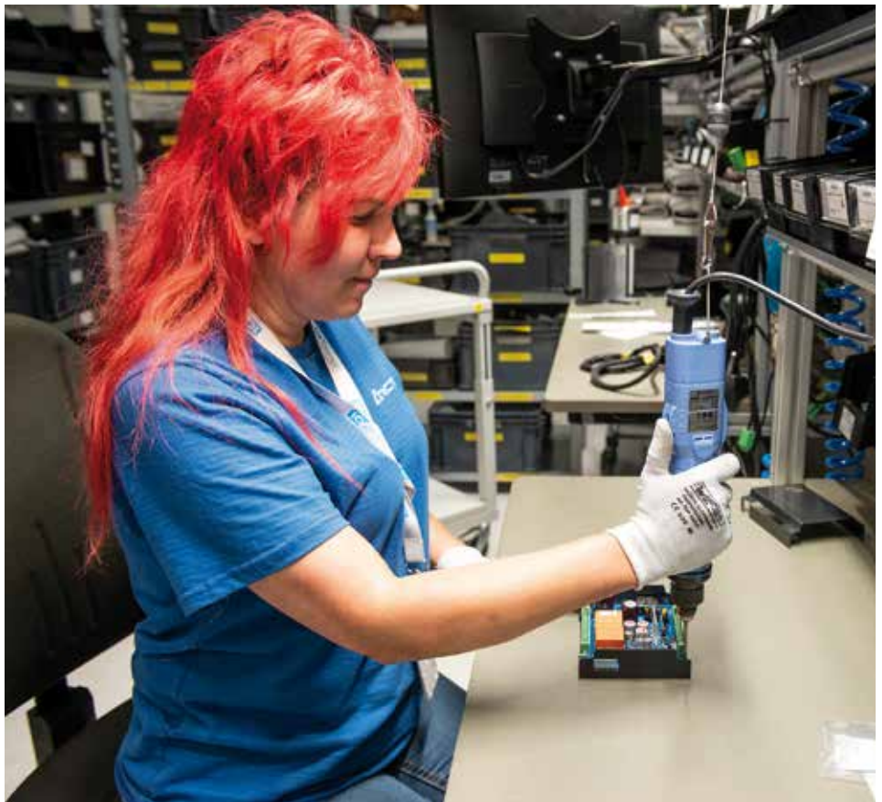
Arcteqin tuotteiden loppukokoonpano tapahtuu yhtiön omalla tehtaalla. Marjo Verkkomäki kiinnittää tässä piirilevyä laitteen koteloon.
