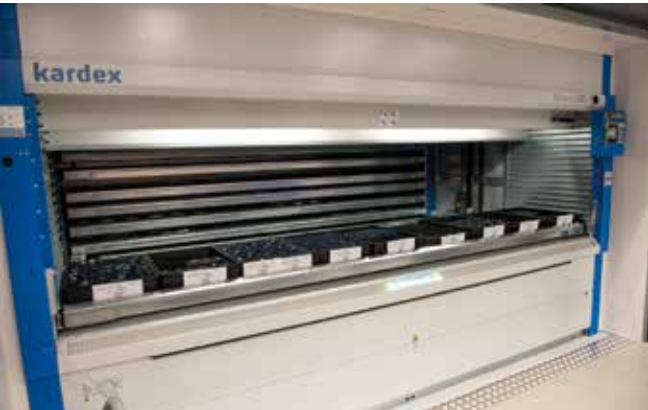
Uusi, hissiperiaatteella toimiva varastoautomaatti on neljä metriä leveä ja seitsemän metriä korkea.
