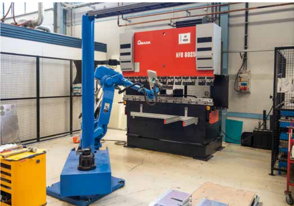
Amada-särmäyspuristin varustettuna Yaskawa-käsivarsirobotilla on tuonut Klaukkalaan lisää kapasiteettia ohutlevyosien tuotantoon.
