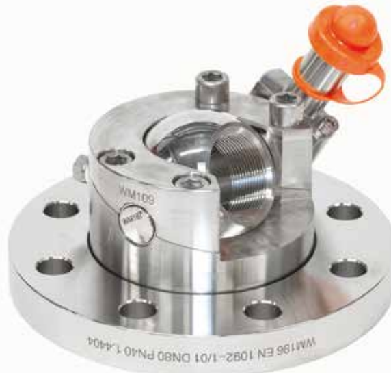
Satron PASVE -asennus- ja huoltoventtiili vähentää oleellisesti huoltoseisokkien tarvetta. Sen avulla lähes mikä tahansa mittalähetin voidaan liittää ja irrottaa toiminnassa olevaa prosessia häiritsemättä.
