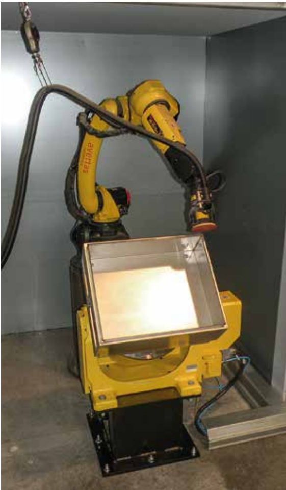
Hiontarobotti työstää hitsatun kaapin saumat hellävaraisesti ja väsymättömän tarkasti.
