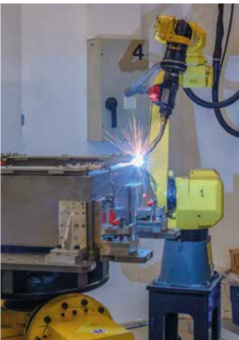
Robotti hitsaa saumaa lähes käsittämättömän nopeasti ja hitsausjälki on erittäin korkealaatuinen.
