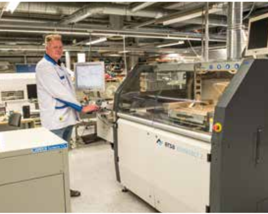
Elektroniikan 3K-tehtaalla on monia laitteita ja palveluita, joita myös Darekon voi hyödyntää. Vasemmassa kuvassa Harri Reinikainen esittelee selektiivijuotoskonetta, joka on tehtaan uusiin han-
