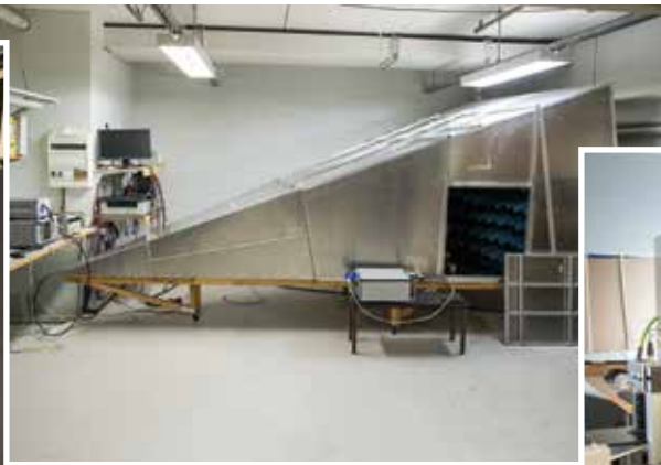
kinta. Keskellä on itse valmistettu ”suunta-antenni” radiohäiriöiden testaamiseen ja oikealla Reinikainen ja projekti-insinööri Henri Montonen tarkastelevat piirikorttia röntgenlaitteen ääressä.
