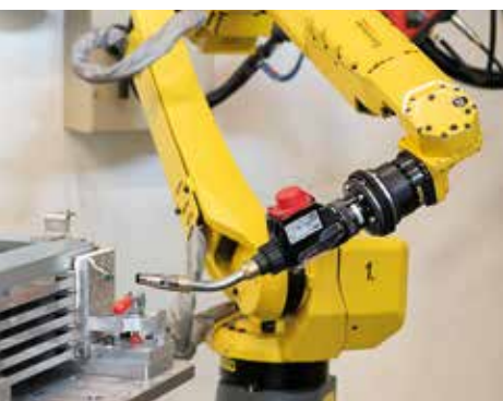
Hitsausrobotti pystyy vetämään saumaa 10 kertaa nopeammin kuin ihminen.
