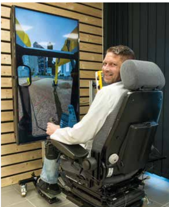
Novatronin kaivinkonesimulaattori olisi joka pojan toiveleikkikalu. Vakavammassa käytössä sen avulla opetellaan havainnollisesti 3D-mittausjärjestelmän toimintaa ja käyttöä.
