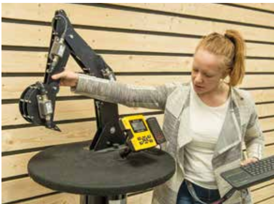
Novatronin viestintäkoordinaattori Elina Puurunen näyttää yhtiön koulutustiloissa Xsite EASY -mittausjärjestelmän toimintaa. Puomiston mallista ilmenee kiihtyvyyssantureiden sijoittaminen ja ledimatriisi näyttää, pitääkö kauhaa nostaa vai laskea.
