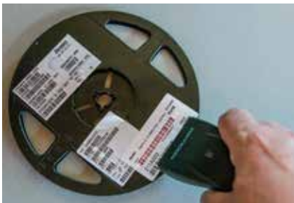
Komponenttikelasta tai -pakkauksesta luetaan Darekonin materiaaliosaston luoma PUI-koodi, jonka sisältämät tiedot liitetään jokaiseen piirilevyyn, jonka valmistuksessa kyseistä komponenttiterää käytetään.
