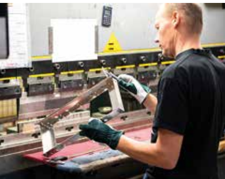
Uudesta särmättävästä tuotanto-erästä tarkastetaan, että mitat ovat varmasti kohdallaan.
