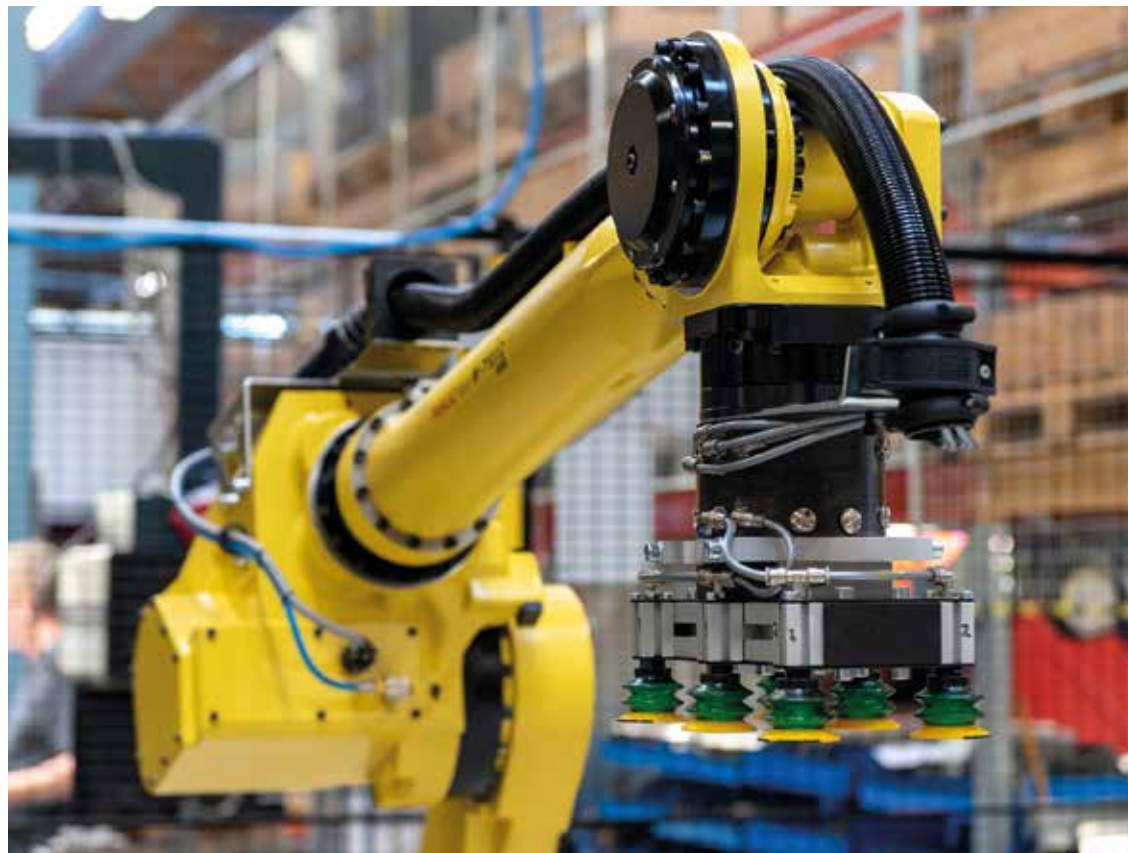
Klaukkalan uusi tiivisteiden pursotuslaitteisto käyttää Fanuc-käsivarsirobotia, minkä ansiosta tiivisteitä voidaan pursottaa myös monitahoisiin kappaleisiin.
