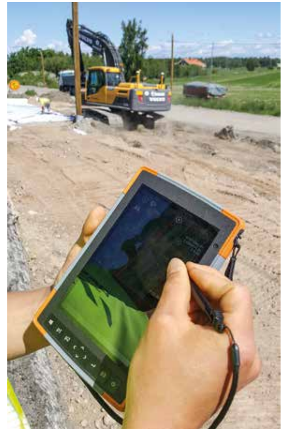
Xsite PAD on työkalu mittajille ja työnjohtajille. Se sisältää samat ominaisuudet kuin Xsite PRO 3D -koneohjausjärjestelmä, mutta sen toiminnot on suunniteltu työmaan toiminnasta vastaavien henkilöiden tarpeisiin.
