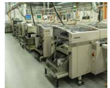
Siemens-ladontalinja sai Savonrannassa päivityksen, kun siihen lisättiin etualalla olevat kaksi entistä tarkempaa ja nopeampaa ladontakonetta.
