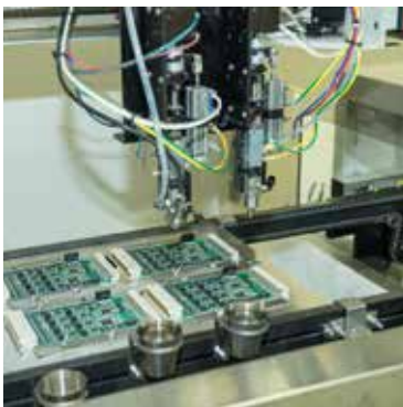
Automaattinen lakkausrobotti levittää suojalakan selektiivisesti haluttuihin kohtiin piirilevyä.
