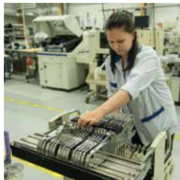
Emilia Jääskeläinen valmistelee komponenttikasetteja ladontakoneelle seuraavan tuotteen valmistusta varten.
