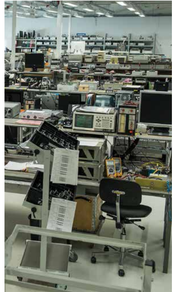
Valmiiden korttien funktionaaliseen testaukseen on oma alueensa, joka on varustettu tarpeellisilla mittalaitteilla.
