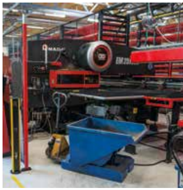
Klaukkalan tehtaan kolme vuotta sitten uusittu FMS-järjestelmä on servokäyttöinen, säästää oleellisesti energiaa, eikä tarvitse hydraulioiljyä.
