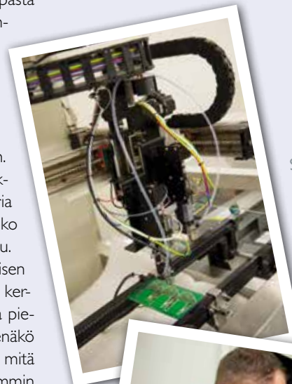
Sähköinen testaus varmistaa, että kaikki toimii kuten pitääkin.
