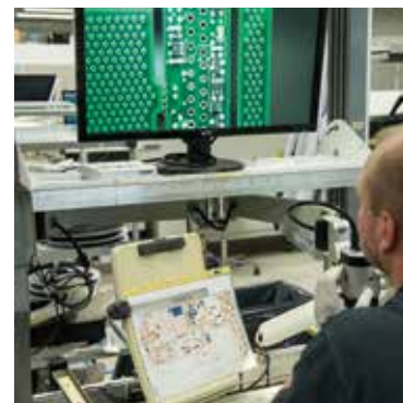
Reflown jälkeen tarkat silmät varmistavat ladonnan ja juotoksen virheettömyyden.
