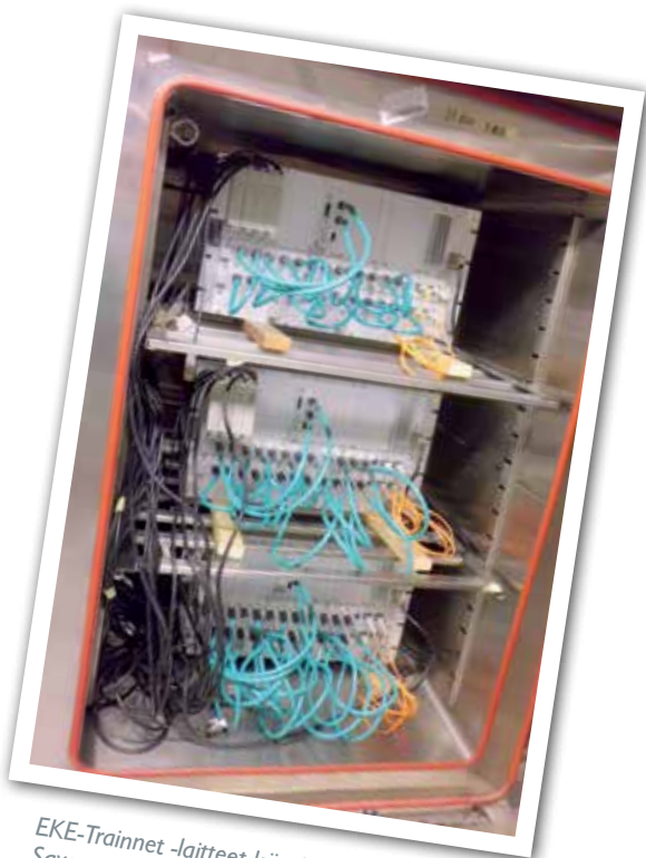
Rekisteröintilaitteiden toiminta testataan huolellisesti ennen toimitusta. Jos laite ei toimisi, saa juna ajaa vain hitaasti lähimmälle varikolle.
